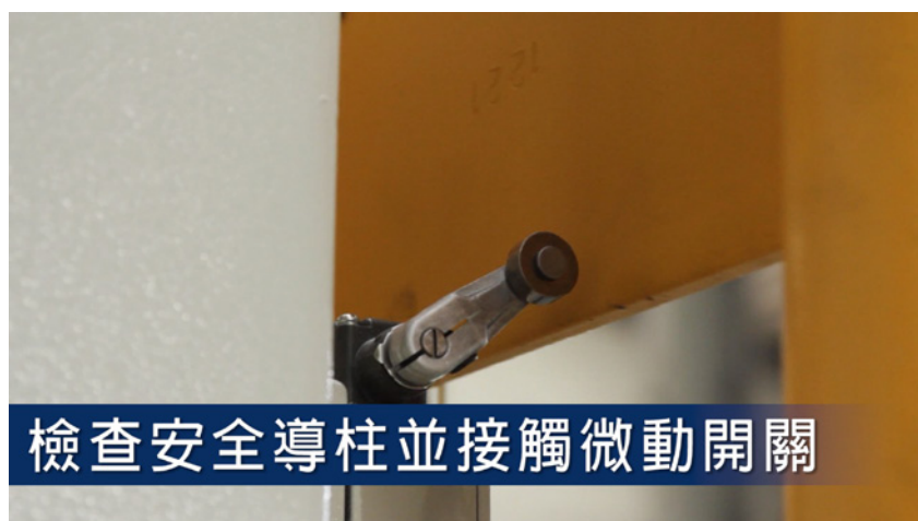
檢查安全導柱並接觸微動開關
