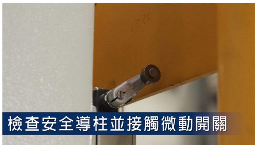
檢查安全導柱並接觸微動開關
